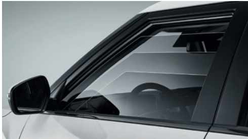
Электрический стеклоподъемник двери водителя с функцией защиты от защемления
